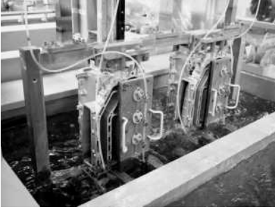
アルマイト処理中の船外機部品。F140Bの一部仕様に量産機種として初採用した。量産船外機のエンジン部品へのアルマイト処理の試験機「AQ7200」を発売した。
